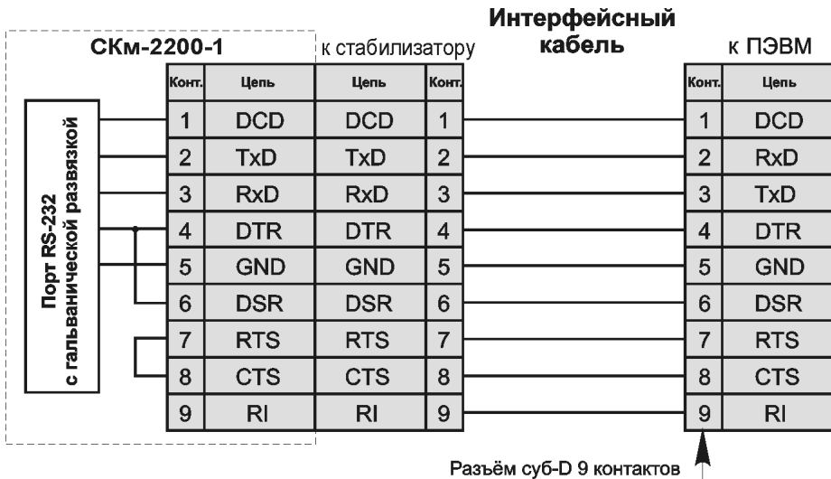
Рисунок 6 – Схема электрическая соединения стабилизатора с ПЭВМ
