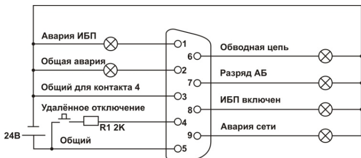
Рисунок 9 – Электрическая схема организации контроля и управления ИБП с электропитанием от источника постоянного тока напряжением +24 В
