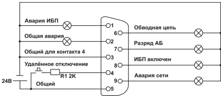
Рисунок 14 – Электрическая схема организации контроля и управления ИБП с электропитанием от источника постоянного тока напряжением +24 В
