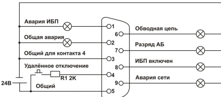
Рисунок 12 – Электрическая схема организации контроля и управления ИБП с электропитанием от источника постоянного тока напряжением +24 В
