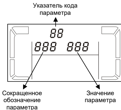
Рисунок 10 – Назначение индикаторов LCD-дисплея при работе в режиме установки параметров
