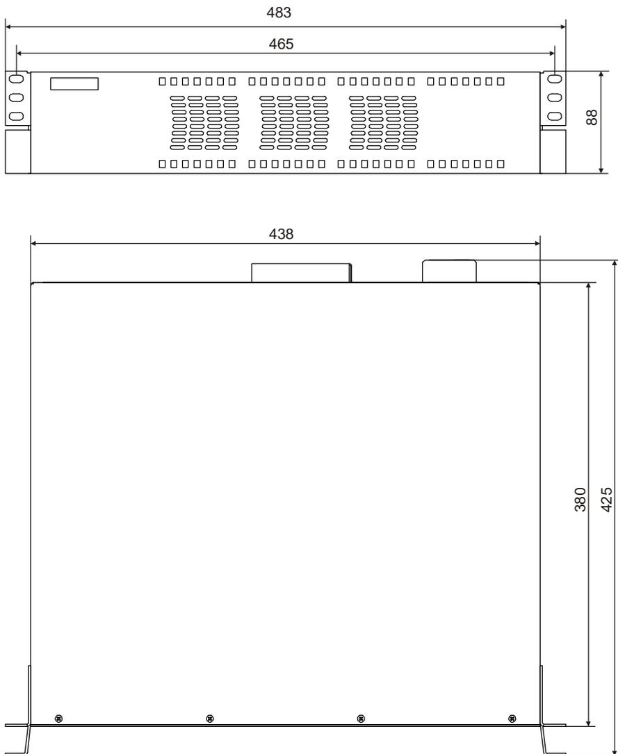
Рисунок А.1 – Габаритные и установочные размеры БМ
