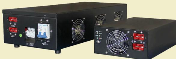
Зарядные устройства обеспечивают возможность подключения к ИБП дополнительных батарейных модулей или батарей, для увеличения времени работы системы бесперебойного электропитания в автономном режиме.
