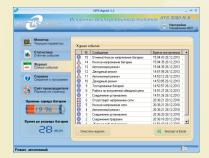
**Дистанционный контроль и управление**: по последовательному порту RS-232 или USB с помощью ПО **UPS Agent**, по релейному интерфейсу AS/400, а так же глобальный мониторинг и управление в сетях Internet/Intranet по протоколу SNMP при помощи WEB/SNMP-адаптера WEBtel II ES AUX.
