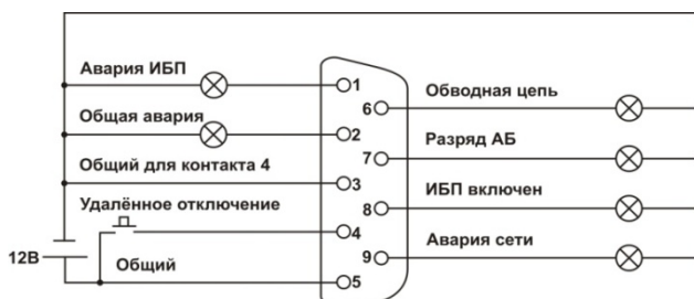
Рисунок 13 – Электрическая схема организации контроля и управления ИБП с электропитанием от источника постоянного тока напряжением +12 В
