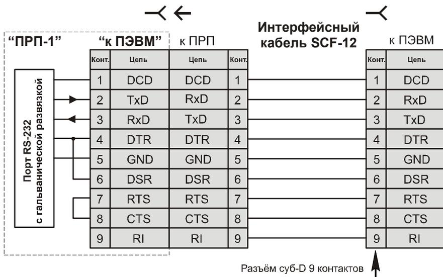
Рисунок 9 – Схема электрическая соединения ПРП с ПЭВМ
