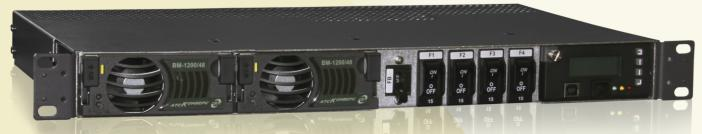
СБЭП предназначена для электропитания аппаратуры связи и телекоммуникаций, а также промышленного оборудования различного назначения постоянным напряжением 48 В в буфере с аккумуляторной батареей (АБ) или без нее. Изделие рассчитано на работу от однофазной сети переменного тока 220 В частотой 50 Гц, а также от резервных двигатель-генераторных установок.
