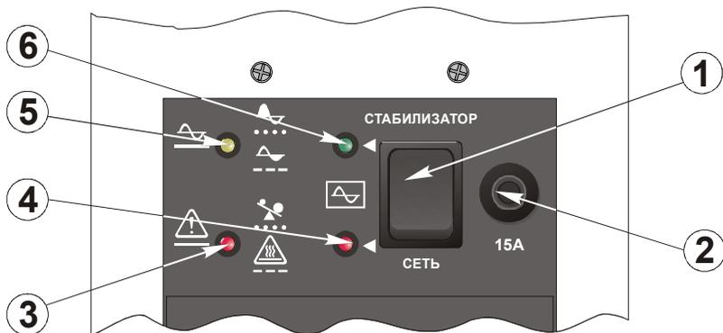
Рисунок 3 – Органы управления и индикации стабилизатора
