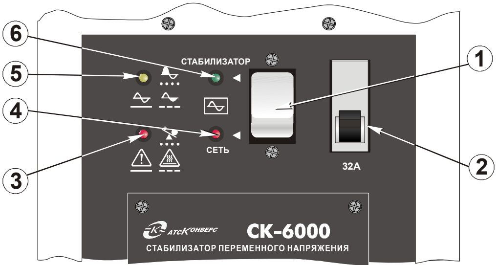
Рисунок 3 – Органы управления и индикации стабилизатора
