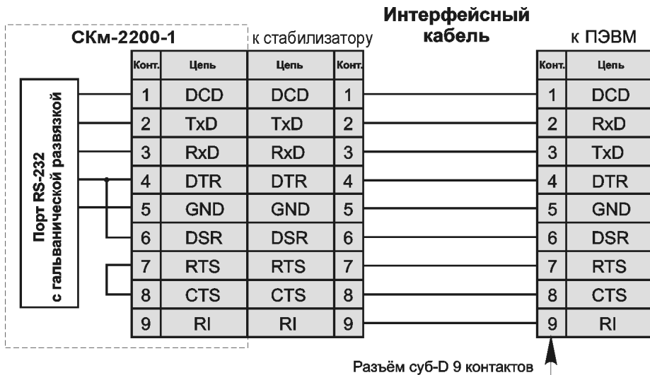
Рисунок 6 – Схема электрическая соединения стабилизатора с ПЭВМ
