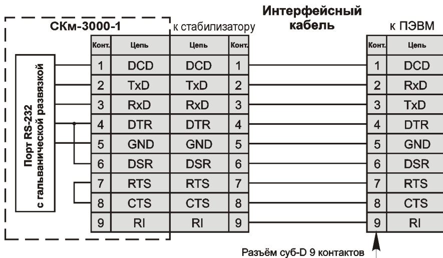
Рисунок 6 – Схема электрическая соединения стабилизатора с ПЭВМ
