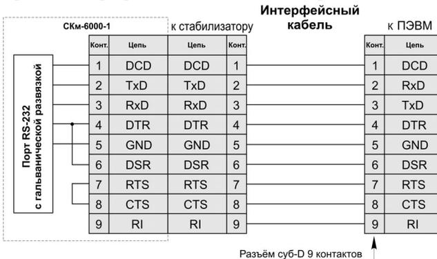
Рисунок 7 – Схема электрическая соединения стабилизатора с ПЭВМ
