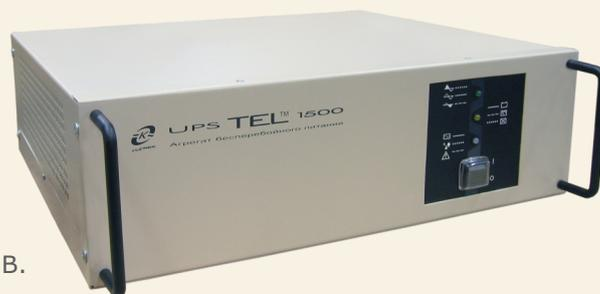
АБП пригодны для работы на объектах, где имеется резервная аккумуляторная батарея напряжением 24/48/60 В. Обеспечивают питание электроприёмников с потребляемой мощностью до 900/1500 ВА.
