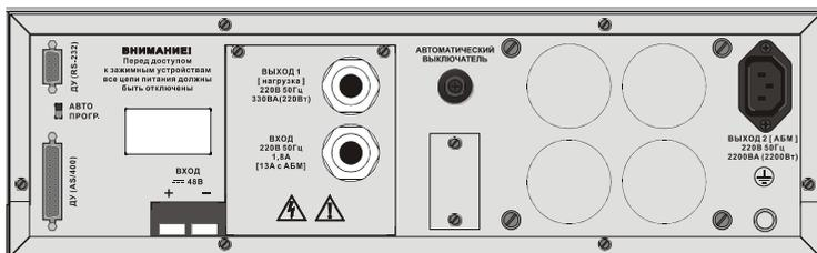
Вид задней панели АБП исполнения со стационарным подключением
