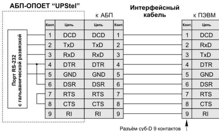
Рисунок 13 – Схема электрическая соединения АБП с ПЭВМ
