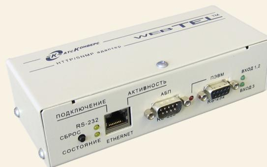
Электропитание адаптера может осуществляться **одновременно от двух независимых источников**: постоянного тока (в диапазоне **от 19 до 86 В**) и переменного тока (**220 В, 50 Гц**), что существенно повышает надежность его работы. Дополнительно адаптер оснащен схемой **защиты от глубокого разряда внешних аккумуляторных батарей**, от которых может производиться его электропитание.
