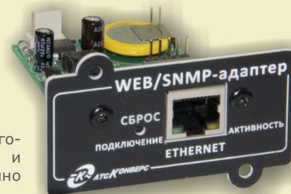
Адаптер представляет собой интеллектуальное устройство, устанавливаемое в коммуникационный порт ИБП, с программируемым пользователем IP-адресом и предназначен для непосредственного подключения ИБП к Ethernet сети.
