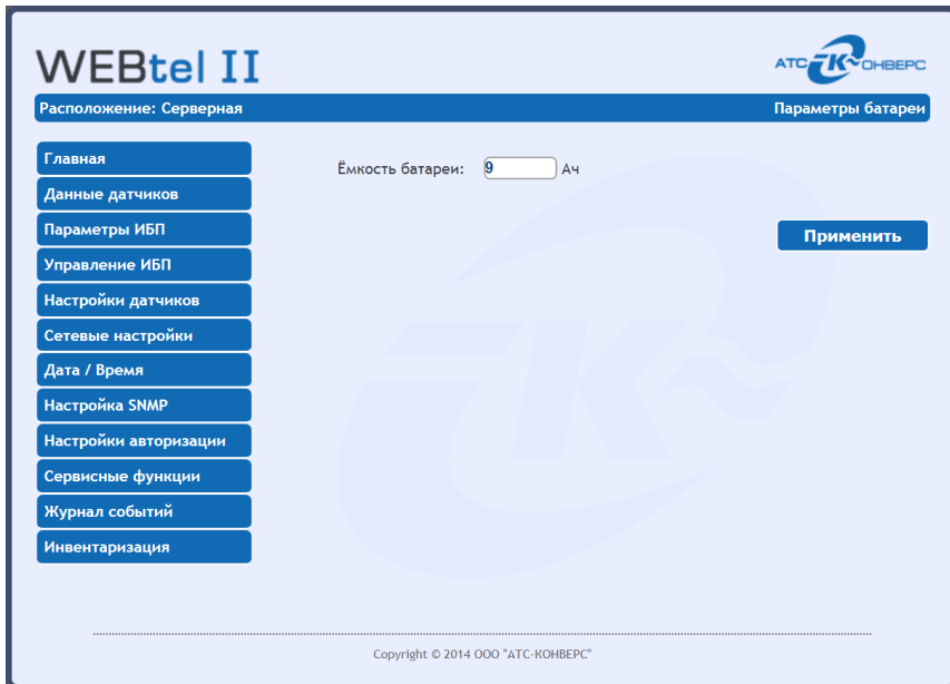
Рисунок 14 - Страница настройки параметров батареи для однофазных ИБП мощностью 1-3 кВА
